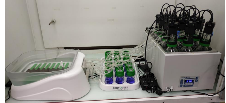
Système de mesure du BMP : AMPTS
