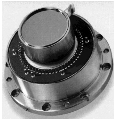
Fig. 30 Photographie est issue de la référence [24]. Le temps de refroidissement est de 2min30 @20°C et nécessite une puissance électrique de 8W. Le maintien en température consomme 3,1W.
