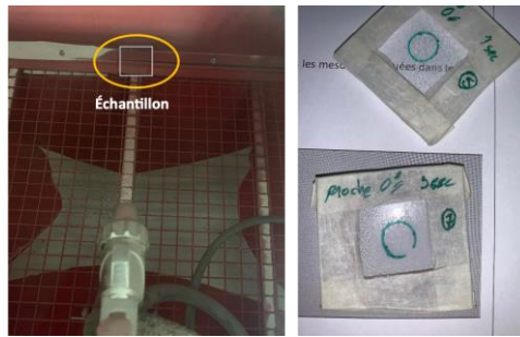
Figure 3. Sablage des échantillons de verre sodo-calcique
