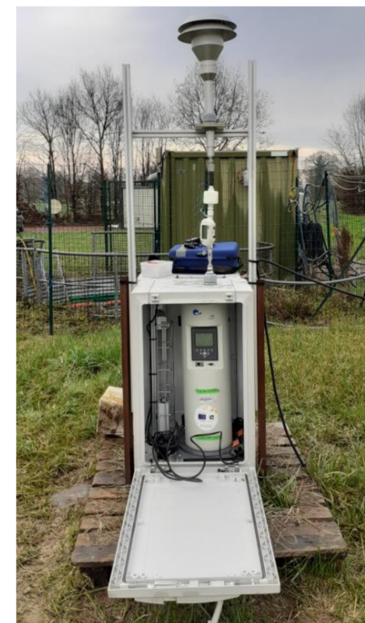
Fig. 3: Système de prélèvement in situ.
