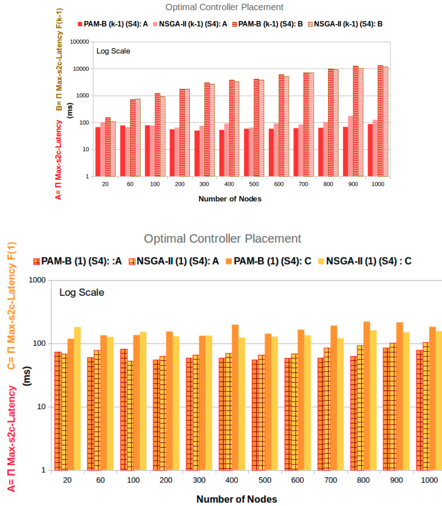
FIGURE 3.5 – Strategie 4 : Mesures de fiabilité : (latences maximales dans les scénarios sans défaillance)
