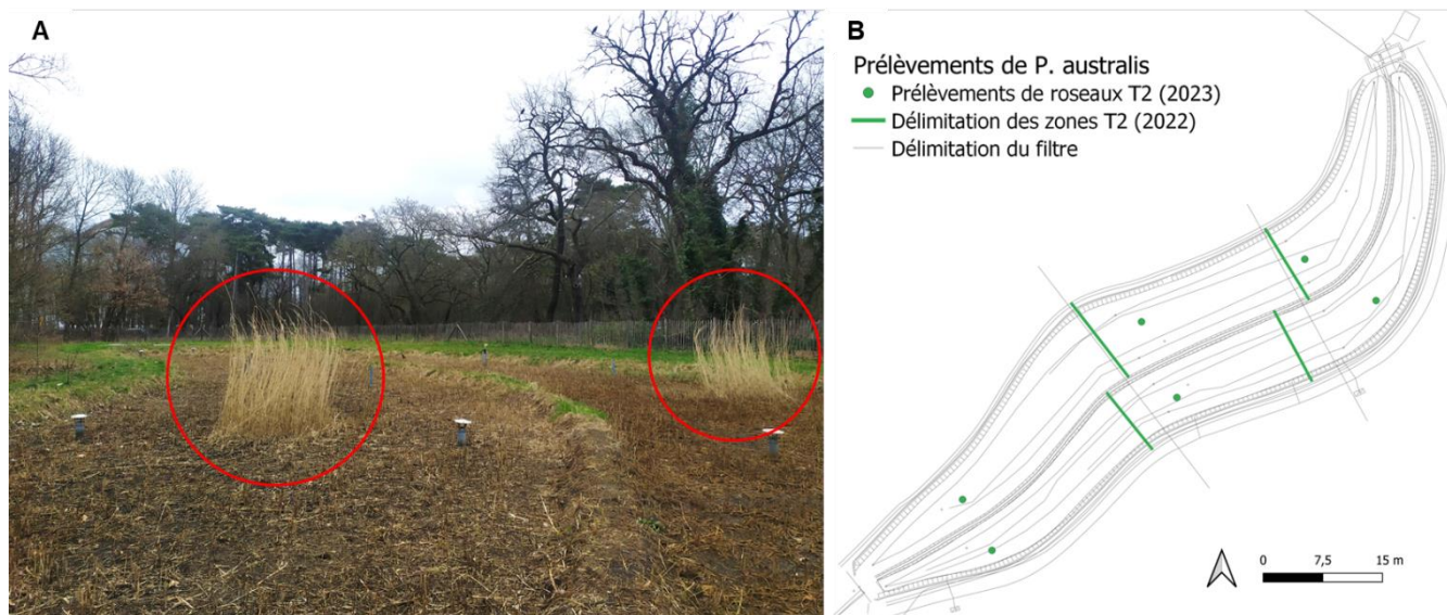
Figure 2.15 : Prélèvements des parties aériennes de P. australis réalisés en mars 2023. A : photographie des quadrats conservés sur place lors du faucardage (Crédit : J. Roux, 2023) ; B : localisation des prélèvements sur les filtres.
