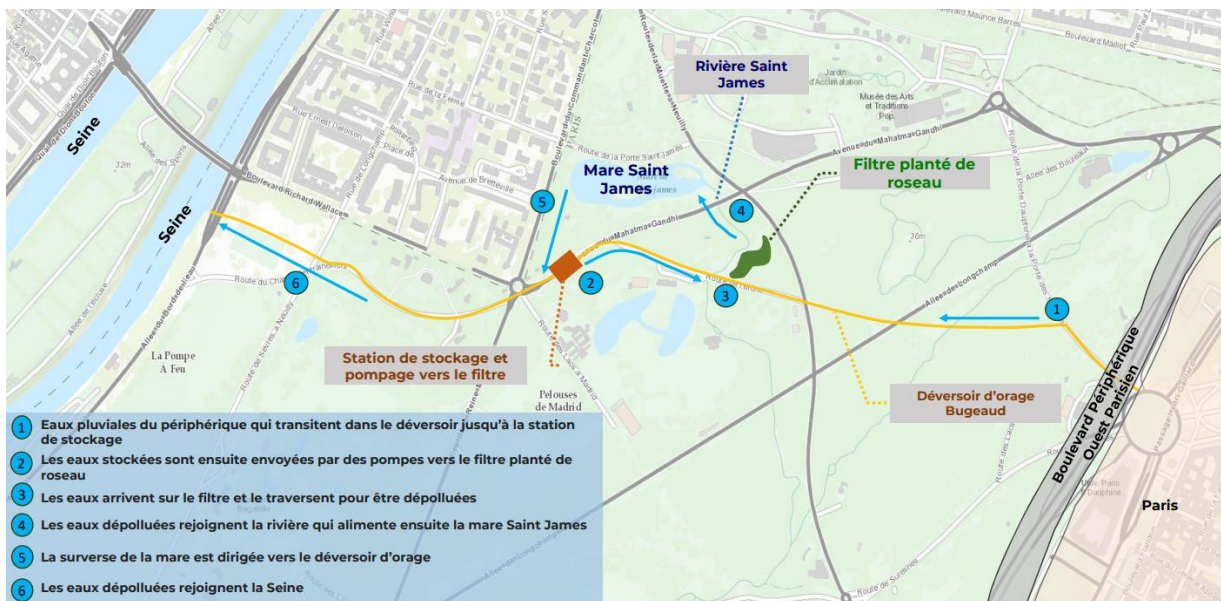
Figure 2.2 : Chemin emprunté par les eaux de ruissellement selon six étapes (1 à 6) (source : Life Adsorb, 2023).
