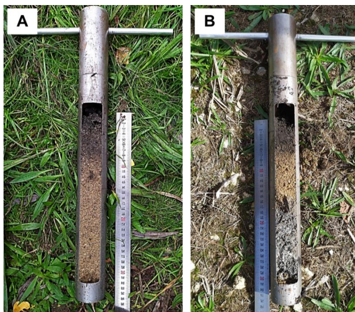
Figure 2.11 : Photographies du carottier et des carottes réalisées dans les deux filtres. La hauteur possible de prélèvement est de 40 cm. B : Photographie d'un exemple de carotte récupérée au niveau du filtre FS ; C : Photographie d'un exemple de carotte récupérée au niveau du filtre FR (Crédit : J. Roux, 2021).
